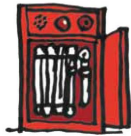
屋内消火栓設備
